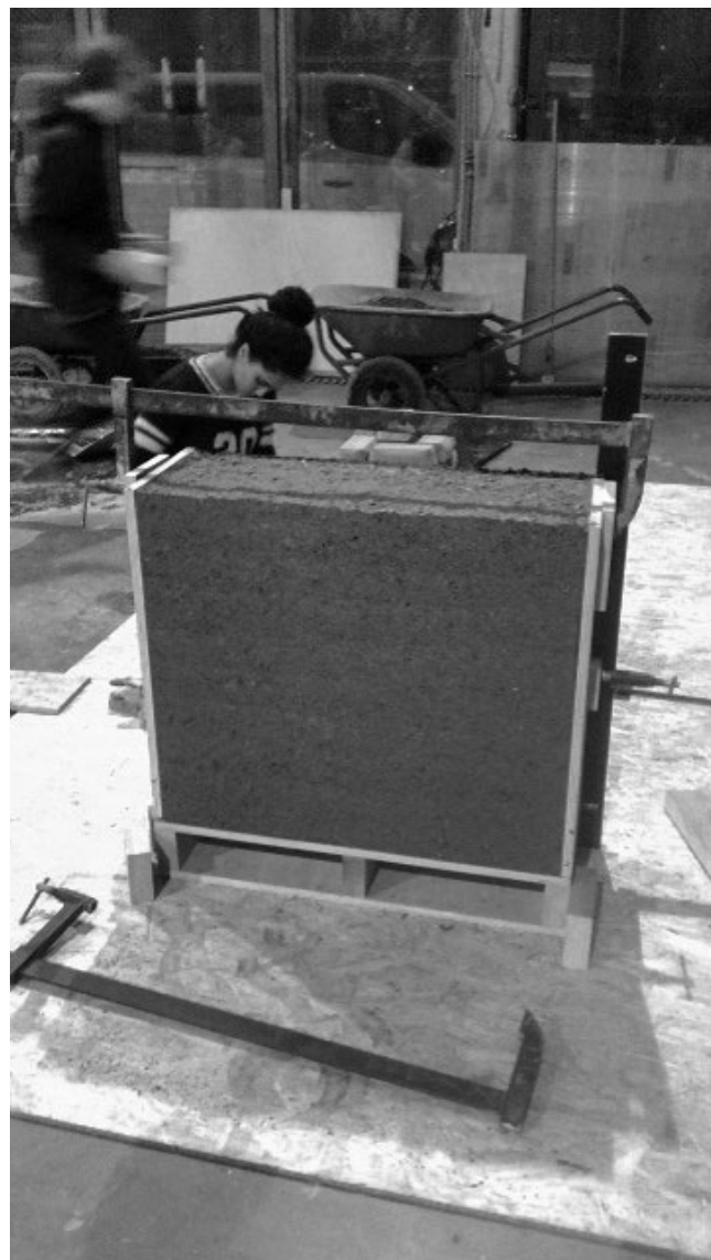
Expérimentation « matériau : pisé de mâchefer » à partir de terre et de cendres d'ordures ménagères, le laboratoire MATEIS et AMÀCO novembre 2018 — © : ENSAL
